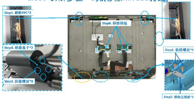
LT350 拆解步骤一B壳(移除HINGE&排线)
